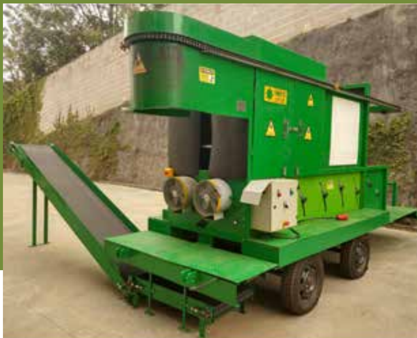
Imagem 52 - Maquinário móvel utilizado para fazer a pelação e limpeza das plantas.
